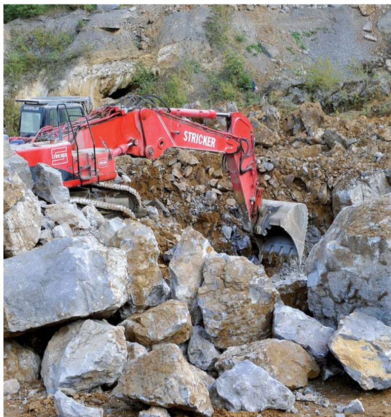
Beim Reinigungsschnitt wird durch Bohren und Sprengen sowie die Aufbereitung des gewonnenen Materials eine ebene Steinbruchsohle hergestellt.
